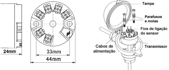
**Obs.: Os transmissores são fornecidos sem os parafusos de fixação.**
